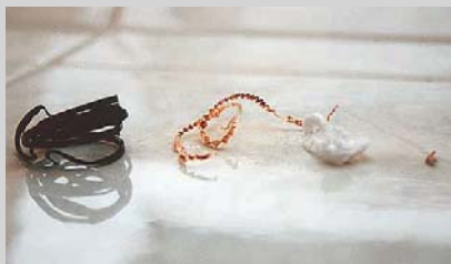
④ Wellmantelkabel wird mit einem Absetzwerkzeug (links oben) für die Montage des HF-Verbinders vorbereitet. Nach dem Absetzen in einem Arbeitsschritt ist das Kabel maßhaltig bearbeitet und der Innenleiter angefasst (oben). Links die Abisolierreste nach Einsatz des Absetzwerkzeuges: Außenmantel, Schirmmantel, Dielektrikum, Innenleiter
