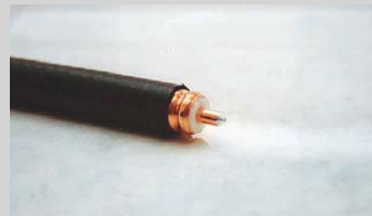
④ Wellmantelkabel wird mit einem Absetzwerkzeug (links oben) für die Montage des HF-Verbinders vorbereitet. Nach dem Absetzen in einem Arbeitsschritt ist das Kabel maßhaltig bearbeitet und der Innenleiter angefasst (oben). Links die Abisolierreste nach Einsatz des Absetzwerkzeuges: Außenmantel, Schirmmantel, Dielektrikum, Innenleiter
