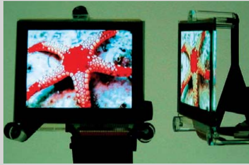
6 Display in OLED-Technologie – die dünnen Bildschirme sind selbstleuchtend und benötigen deshalb keine Hintergrundbeleuchtung. Der Betrachtungswinkel ist wesentlich größer als bei LCD-Anzeigen (siehe rechte Bildseite)
