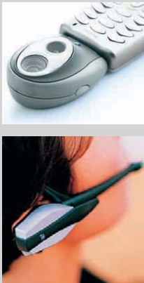
2 Tri-Band-Handy T68 – Bluetooth-Schnittstelle und MMS-Standard ermöglichen ein drahtloses Headset und die Übertragung von Bildern einer Digitalkamera (Foto: Ericsson)
