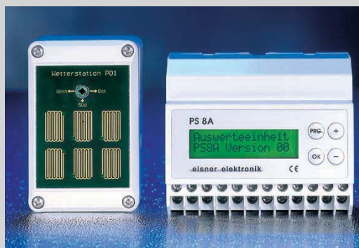
① Wetterdatensystem bestehend aus: – Wetterstation Außenbereich P 01 (links) – Auswerteeinheit mit Tastatur/Display PS 8A
