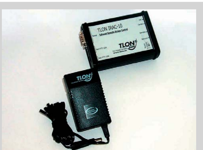
1 Mit dem Tele-Service-Modul IRAC ist die Fernwartung und die Weiterleitung von Meldungen via Telefonnetz aus gebäudetechnischen Anlagen möglich, die über ein LON-Netzwerk verfügen
