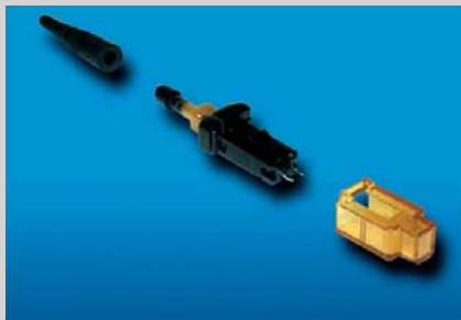
3 Beim Einsatz von einseitig vorkonfektionierten LWL-Kabeln wird nach der Verlegung ein Abschluss mit Steckern durch mechanischen Spleiß hergestellt
