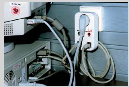
④ Universelles Überspannungsschutzgerät (DATA-Protector) zum Schutz der Netz- und Datenleitungen eines Arbeitsplatzes
