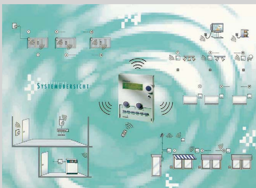
1 Das „Herz“ des Funksteuerungs-Systems ist die Funkzentrale. Hier sind die zeit- und ereignisbezogenen Programme gespeichert. Die Aktoren schalten bzw. regeln Licht, Rollläden und Heizung entsprechend den empfangenen Funksignalen
