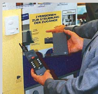
5 Funk-Türsprechanlagen machen die Leitungsverlegung überflüssig
