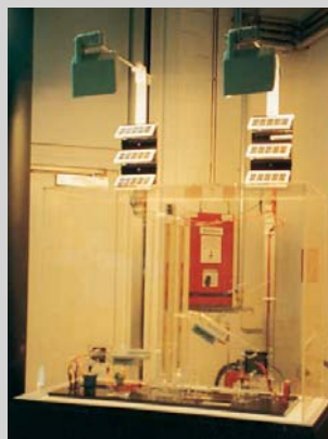
2 Funktionsmodell der H 2 -Gewinnung aus Wasser mit photovoltaisch erzeugtem Strom – hier zur Demonstration mit Kunstlichtquellen
