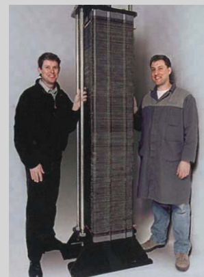
3 Zwei dieser BZ-Stapel (BZ-Stacks) mit jeweils mehreren hundert, elektrisch in Reihe geschalteten Einzelzellen liefern 250 kW.
