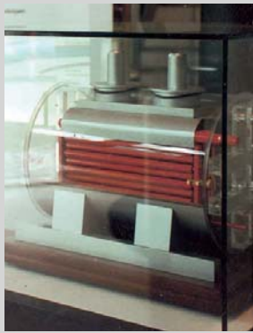
4 Modell einer Hochtemperatur-Brennstoffzelle, Bauart „Hot-Modul“
