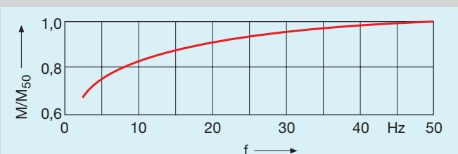
3 Reduktion des Drehmoments bei Umrichterspeisung mit Frequenzen < 50 Hz durch verminderte Kühlwirkung
