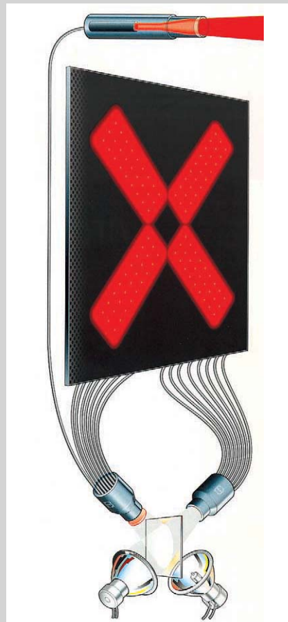
13 Prinzip der Lichtleitfasertechnik für Verkehrszeichen (Foto: Schott)
