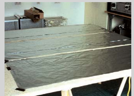
6 Flächenheizelement mit Aluminiumfolie als Schutzleiter im Laborversuch
