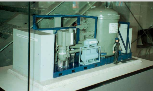
⑧ Modell der 100 kW elektrisch leistenden Versuchsanlage von Siemens-Westinghouse mit der SOFC-BZ. Alles Wichtige darüber ist ebenfalls im BZ-Innovationspark Berlin-Treptow 1) zu erfahren.
