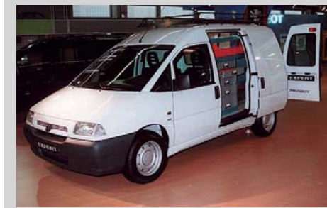
4 Der Peugeot Expert hat eine zweite Schiebetür. Dahinter verbirgt sich ein Regal für Kleinteile, die besser entnommen werden können Fotos: Stefan Wagner
