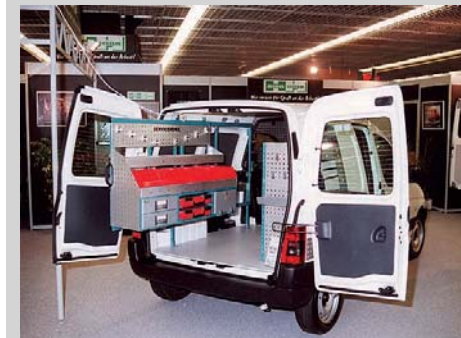
3 Für den Bereich der Kastenwagen gibt es bei den Werkstattausrüstungen ausziehbare Seitenblöcke (Fa. Servicemobil), hier in einem Peugeot Partner (baugleich mit dem Fiat Scudo)
