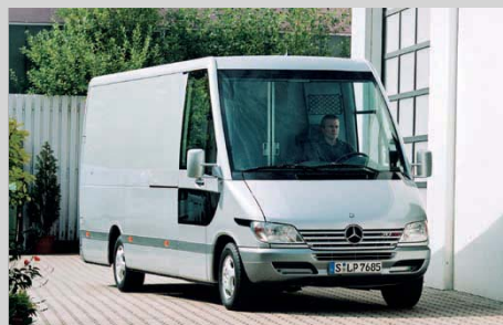
7 Eine Nutzlast von 1500 kg und ein Ladevolumen von 15 m 3 hat die fahrfertige Studie des Alu-Sprinters von DaimlerChrysler
