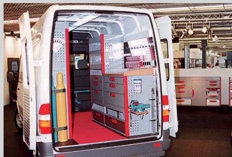
11 Die Hochdachversionen der Transporter, hier ein Sprinter von Daimler-Chrysler, bieten genügend Stehhöhe für Arbeiten im Fahrzeug, Ausbau Bott
