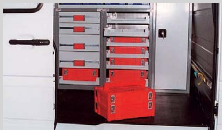
10 Die Werkzeugkisten der Fa. Scheu/BTI lassen sich für den Fußweg zum Kunden zusammenklammern
