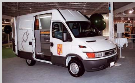
8 Die Fa. Sortimo zeigte auch einen Iveco Daily für die Elektrobranche mit speziellen Halterungen für Kabeltrommeln
