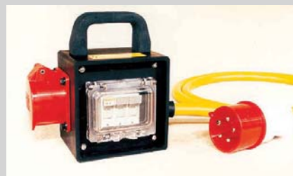
⑤ Normgerechter Übergangsadapter von 32-A-CEE-Drehstrom-Stecker auf 16-A-CEE-Drehstrom-Steckdose, mit zwischengeschalteten Überstrom-Schutzeinrichtungen. (Werkbild ELSPRO)
