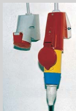
⑥ Unzulässiger einteiliger Adapter mit CEE-Drehstrom-Stecker und starr angeschlossener 16-A-Schuko-Kupplungsdose, betrieben an einer 32-A-CEE-Drehstrom-Steckdose
