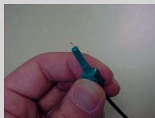
⑤ Verriegelung der Simplexstecker: Beide Steckerhälften werden mit den Fingern zusammengedrückt, bis sie verrasten
