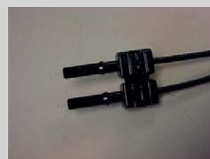
⑥ Duplexstecker anbringen: Zwei gleiche LWL-Stecker (crimpless) können zu einem Duplexstecker zusammengesteckt werden
