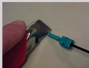
⑦ Faser schneiden: Die überstehende Faser wird mit einem geeigneten Schneidewerk a) mit einem Cutter am Stecker sauber abgetrennt
