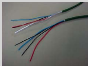
① Das Systemkabel wird mit geeignetem Werkzeug (z. B. Kabelmesser) auf die gewünschte Länge abgesetzt; Polyesterfließ abschneiden
