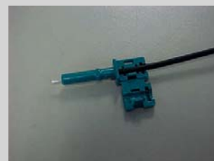
④ Die LWL-Stecker werden bis zum Anschlag auf die Faser gesteckt, so dass die Faser aus dem Stecker übersteht
