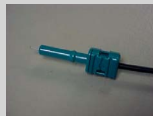
⑤ Verriegelung der Simplexstecker: Beide Steckerhälften werden mit den Fingern zusammengedrückt, bis sie verrasten
