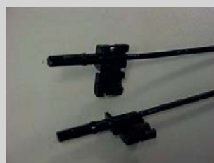
⑥ Duplexstecker anbringen: Zwei gleiche LWL-Stecker (crimpless) können zu einem Duplexstecker zusammengesteckt werden
