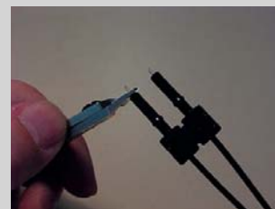
⑥ Duplexstecker anbringen: Zwei gleiche LWL-Stecker (crimpless) können zu einem Duplexstecker zusammengesteckt werden
