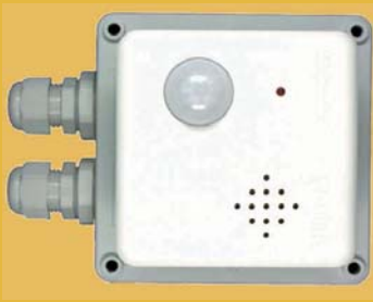
❶ Office Node – Multi-Sensor mit LON-Schnittstelle, Multi PID control und Relaisausgängen
