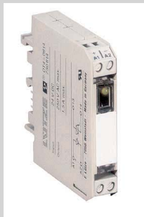
22 Zweikanaliger Koppelbaustein zum schnellen, kontaktlosen Schalten von AC/DC-Strömen bis 1,5 A bei maximal 60 VDC oder 250 VAC (Foto: Lütze)
