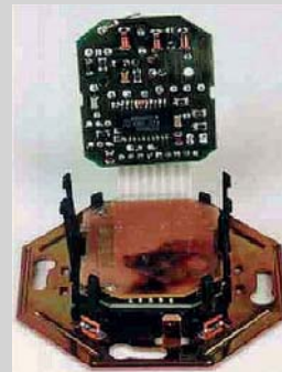
② Überspannungsschaden an BCU
