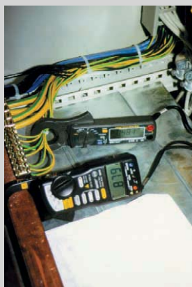
5 und 6 Die Messung der Ableitströme wurde als Alternative zur Isolationsmessung angewandt
