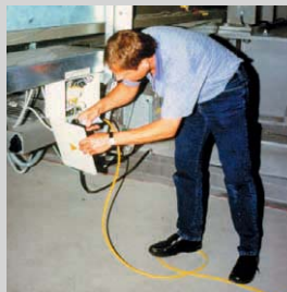
2 bis 4 Die Durchgängigkeit des Schutzleiters wurde an allen relevanten Punkten geprüft
