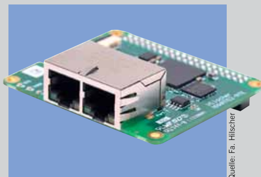
2 Net-Hat – Erweiterungsmodul für den Raspberry Pi
