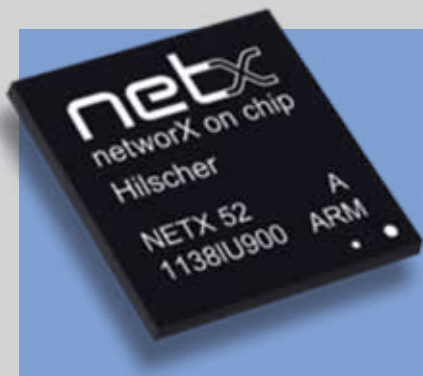
1 Net-X – Netzwerkcontroller (ASICs)
