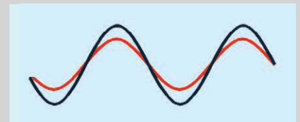
7 Oberwellenfreie Netzspannung der Delta-USV rot Strom blau Spannung
