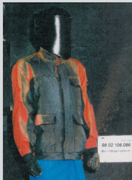
2 Lichtbogenversuche an einem Hausanschlusskasten bei VEW euro-test
