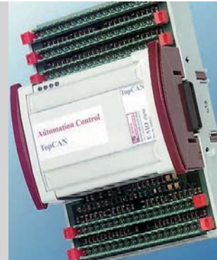
2 Dezentrale Automatisierungseinheit zur Vernetzung mit dem aus der Automobilindustrie stammenden CANopen, einem der im Automatisierungsbereich um Anerkennung bemühten Bussysteme. (Foto: bebra electronic)
