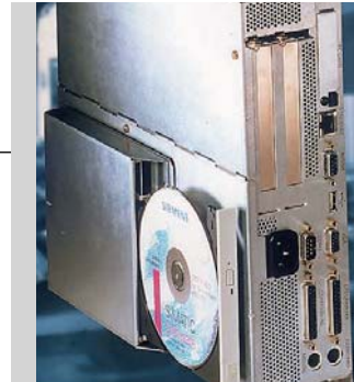
1 Simatic Box PC – ein IPC in den Abmessungen 295 x 265 x 100 mm 3 für Schrank-, Pult- und Maschinenbau. Durch seine hohe elektromagnetische Verträglichkeit ist selbst ein Einsatz als Steuerungszentrum in Kleinbetrieben wie im Wohnbereich möglich. (Foto: Siemens)
