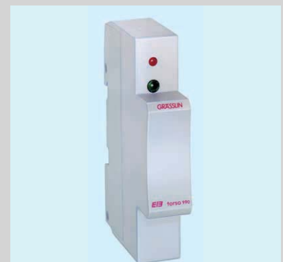
④ Controller tracon torso 990 EIB für die Verknüpfung von Zeit und Ereignis Der Anwendungsbaustein tracon EIB ist in einem gleichartigen Gehäuse untergebracht. Er dient als Schnittstellenbaustein, um den PC mit tracon dialog an den Bus EIB zu koppeln.
