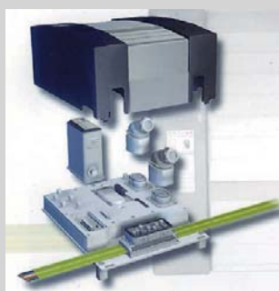
❹ Die intelligenten Feldgeräte (Motorstarter, Frequenzumrichter) werden über den Flachleitungsträger, der Bestandteil des Trägermoduls ist, an den Energiebus angeschlossen. Der Träger nimmt die Busanschaltung, die Leistungselektronik und die Motorstecker auf.
