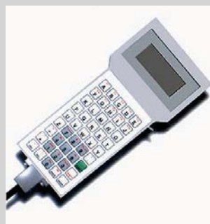
❺ Die Parametrierung und die Busüberwachung kann mit einem Handbediengerät erfolgen.
