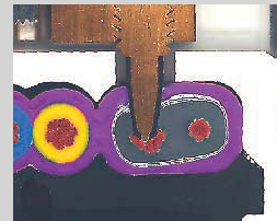
④ Um einen Kurzschluss zu verhindern, sind die Spitzschrauben im Busteil im vorderen Bereich isoliert
