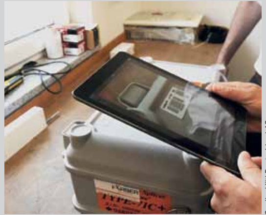
3 Mit mobilem Endgerät ein Glasfaserspleißgerät über ein Etikett mit Barcode in der Software erfassen
