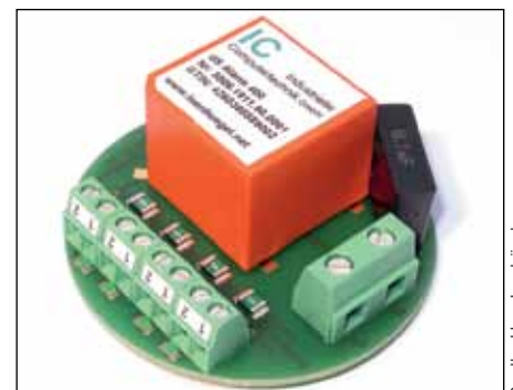
dS-Alarm-Modul zum Anschluss von vier Sensoren – z. B. Fensterkontakten
