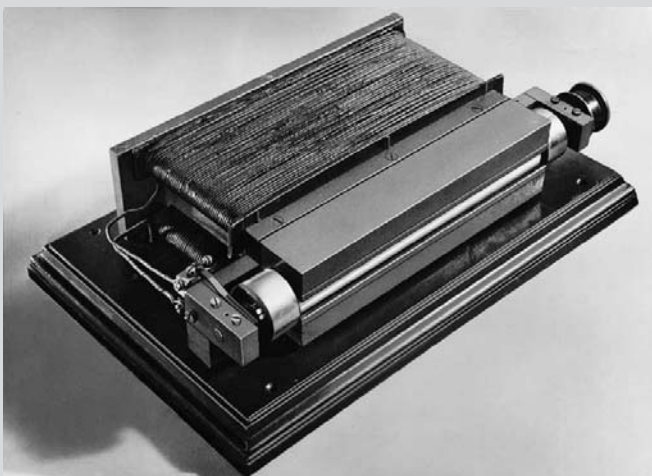
① Die Dynamomaschine aus dem Jahre 1866 von Werner v. Siemens (Quelle: © Siemens Forum München)
