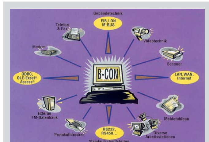
1 B-CON ermöglicht die Integration und das Management von Gebäudeautomations-Funktionen
