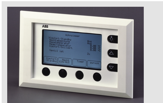
8 EIB-Melde- und Bedientableau MT 701 Foto: ABB
