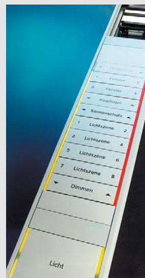
❷ Raumbediengerät für die Gebäudeautomation DIALoc-Room Control Panel RCP (Foto: Weidmüller)
