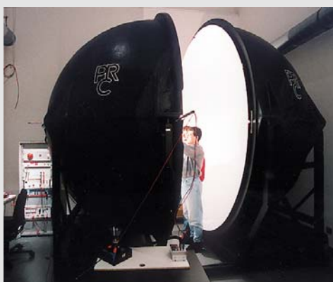
2 Mit der photometrischen Kugel (Ulbricht-Kugel) wird der Lichtstrom präzise gemessen
