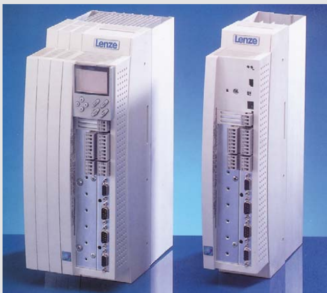
1 Der Servo-Umrichter 9300 gestattet durch seine hohe Funktionalität einen deutlich reduzierten Steuerungsaufwand: Leitfrequenz für Gleichlauf über Steckverbinder, integrierte Lageregler, modulare, frei konfigurierbare Regel-/Funktionsblöcke, integrierter Systembus zur Verknüpfung mehrerer Regler, verschiedene Meßgeber, aufsteckbare Baugruppen für die gängigsten Feldbus-systeme (Foto: Lenze)
