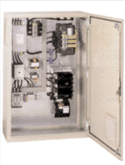
② Aktives Netz-Leistungsfilter , gefertigt von der KBR GmbH in Schwabach in den Abmessungen 600 x 380 x 220 mm mit Statusanzeige, Überwachungen und Busankopplung für universelle Anwendungen Foto: KBR
