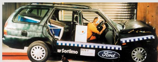
5 Mit Sicherungssystemen geht von der Ladung keine zusätzliche Gefährdung der Insassen aus
