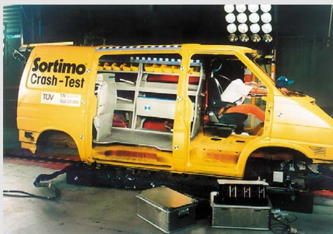
1 Extrem hohe Kräfte wirken auf die Fahrzeuginrichtung bei einem Frontalcrash
