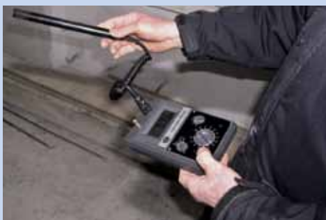
② Überprüfen der baulichen Rahmenbedingungen, hier Temperaturmessungen
