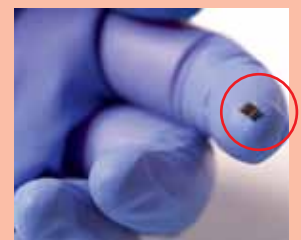
Die Weltrekordsolarzelle mit 44,7 % Wirkungsgrad, bestehend aus vier Teilsolarzellen auf Basis von III-V Halbleitern, für die Anwendung in der Konzentrator-Photovoltaik
