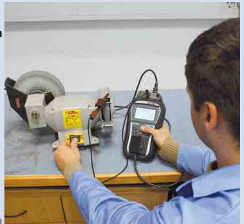
1 Prüfung nach DIN VDE 0701-0702 an verschiedenen Geräten
