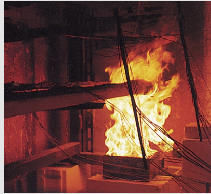
2 Die Trasse während der Beflammung mit 50 kW nach Vorheizung
