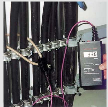
④ Meßwerterfassung eines Stromabzweigs – Standardausführung des Meßgeräts auf der Basis der Rogowski-Spule mit praktischem Schnellverschluß der Meßspule
