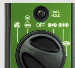
⑥ Mit dem zentralen Drehschalter wird der Kabeltyp eingestellt
