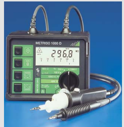
10 Prüfergerät Metriso 1000D nach DIN VDE 0413 für die Prüfung von Anlagen – Messen von Schutzleiterwiderstand, Isolationswiderstand mit 100 V, 500 V und 1000 V Prüfspannung sowie der Netzspannung (Gossen-Metrawatt)
