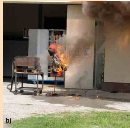
2 a,b Lichtbogentest – enorme Kräfte und Temperaturen werden frei, ein Nachbrennen der Kleidung birgt zusätzliche Risiken
