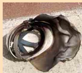
3 Test nicht bestanden – Visier durch die enorme Hitze völlig verformt
