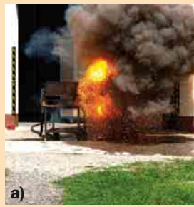
2 a,b Lichtbogentest – enorme Kräfte und Temperaturen werden frei, ein Nachbrennen der Kleidung birgt zusätzliche Risiken
