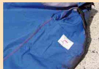
4 Test bestanden – eine zweilagige Jacke aus Proban, innen noch völlig unversehrt
