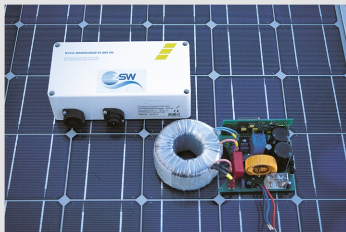
6 Wechselstrom-Solarmodul: Photovoltaik-Modul mit einem in die Anschlußdose integrierten Wechselrichter (Entwicklung/Foto: ZSW)
