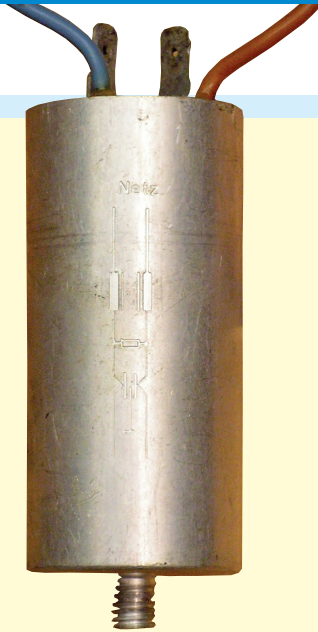
② Der dem äußeren Anschein nach noch vollkommen intakte Filter des zweiten Versuchs
