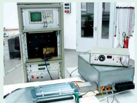
1 Versuchsaufbau zur Bestimmung der magnetischen Schirmdämpfung von Kabeltrag-Systemen Foto: OBO Bettermann
