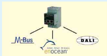
4 Gateways zur Einbindung von M-Bus, Enocean- und Dali-Komponenten
