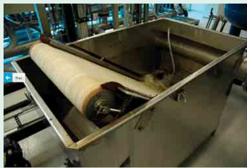
2 Wasserreinigungs- und Waschanlage für die Membranen
