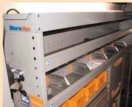
3a Kombination von Stahl und Aluminium
