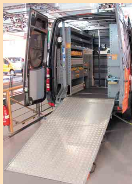
3 Einklappbare, mehrteilige Auffahrampen für das Be- und Entladen schwerer Lasten
