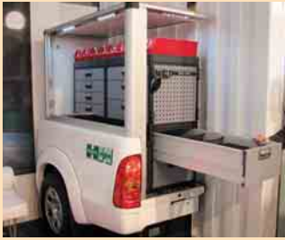
5a Neuer Schubboden mit sehr langen Heck-Schubladen für Pick-Up-Ladeflächen
